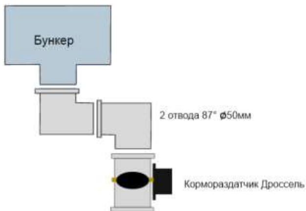
Рис. 3. Установка кормораздатчика через колено
