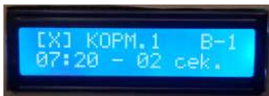
Рис. 8. Настройка времени открытия кормушки
