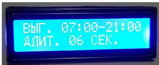
Рис. 11. Время выгула и длительность работы привода
