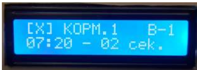
Рис. 6. Настройка времени открытия кормушки
