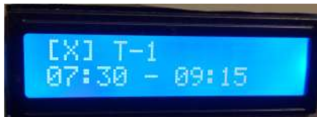
Рис. 7. Настройки реле времени
