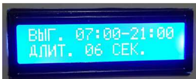
Рис. 9. Время выгула и длительность работы привода
