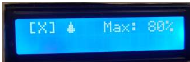
Рис. 8. Настройка реле влажности
